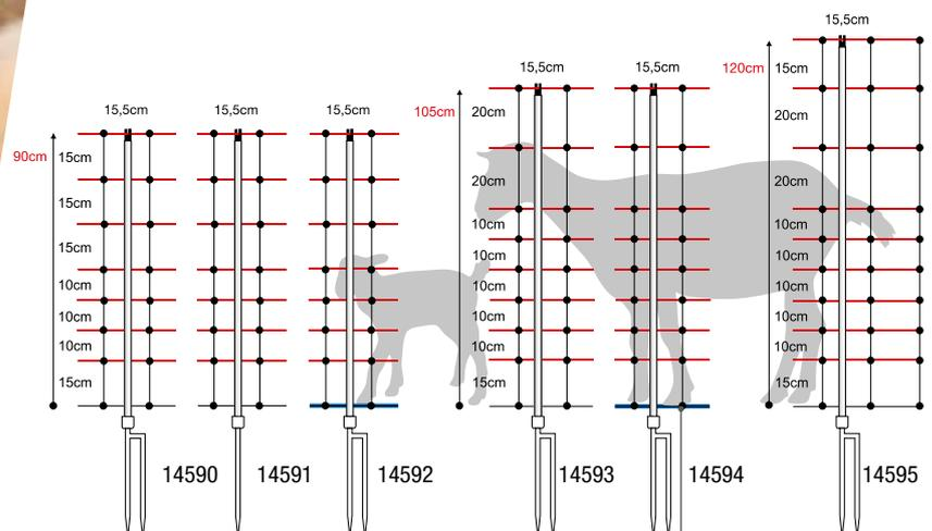
Der zusätzliche Erdleiter sorgt auch bei Trockenheit für eine gute Erdung.
