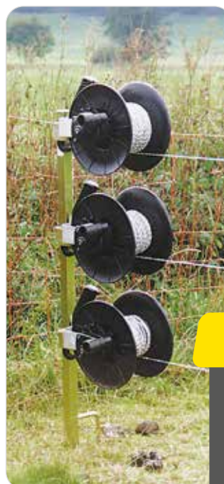
Haspeln an Stahlpfahl montiert
